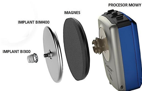
Figure 52 : Baha 4 Attract®: Les deux composants de l'implant sont sous cutanés
